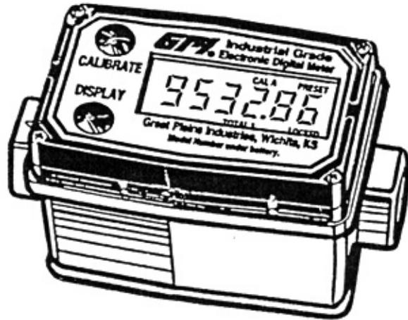
工業級MODEL S050渦輪式流量計的外殼為1/2英吋，可測量水流範圍0.5~10GPM (1.9~37.9 LPM)。標榜大範圍工業級與商業級測量應用。這些渦輪式流量計提供高精準度、精巧的設計與線外型的方式增加多樣性來配合各式的特殊需求。
